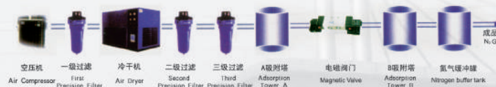
▶ 标准型小型食品包装专用制氮机工艺流程图
